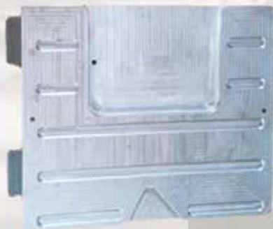
Tôle sous moteur 2cv
